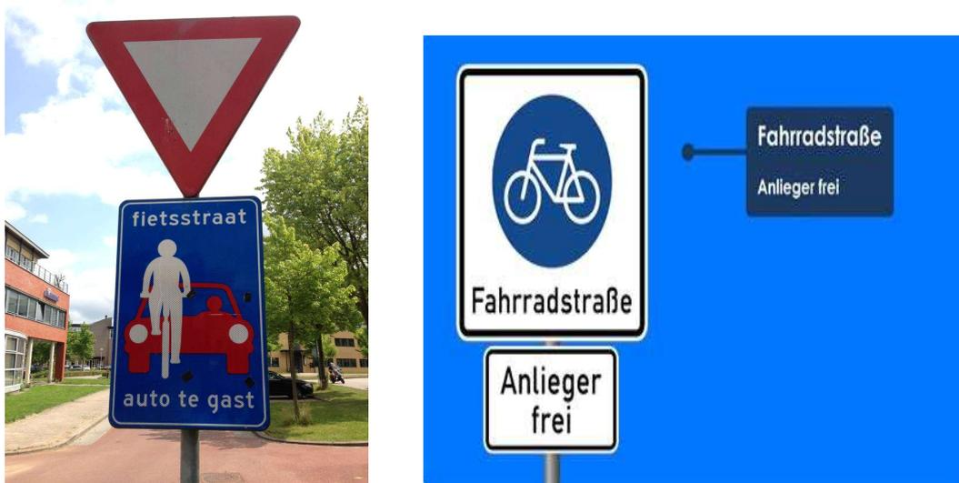
Durch die Kennzeichnung als Fahrradstraße wird eine Fahrbahn vorrangig dem Radverkehr zur Verfügung gestellt, das bedeutet, die gesamte Fahrbahn wird Radweg. Dies kann nach der Verwaltungsvorschrift zur StVO dort erfolgen, wo der Radverkehr die vorherrschende Verkehrsart ist **oder dies alsbald zu erwarten ist**.
